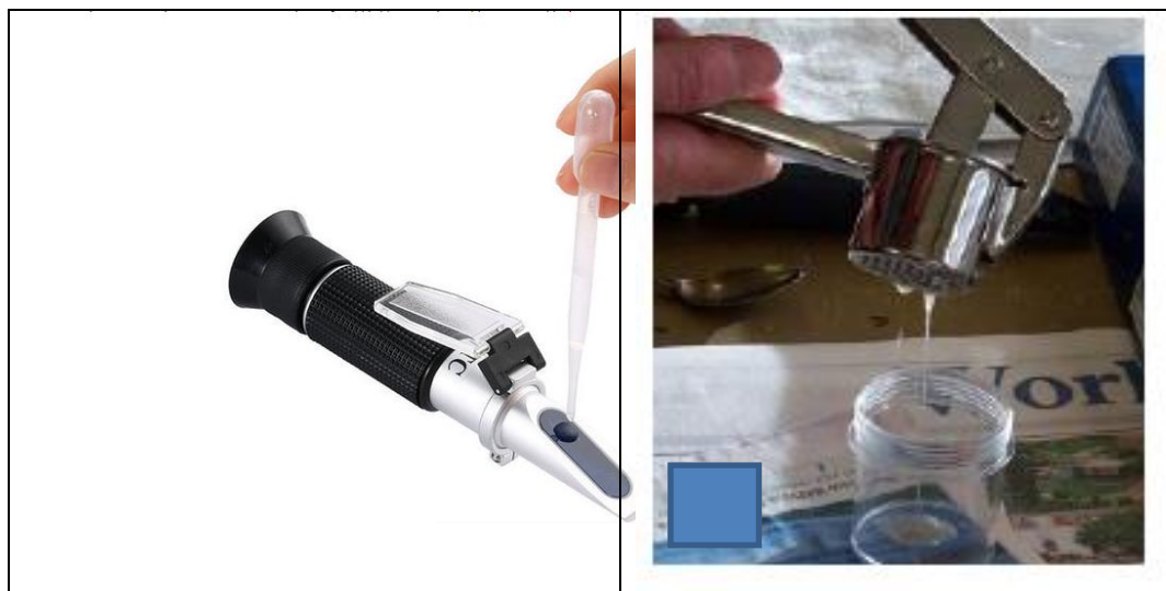
Рис. 6. Процедура отримання соку із коренів спаржі та визначення у ньому вмісту цукру за допомогою польового рефрактометра.
