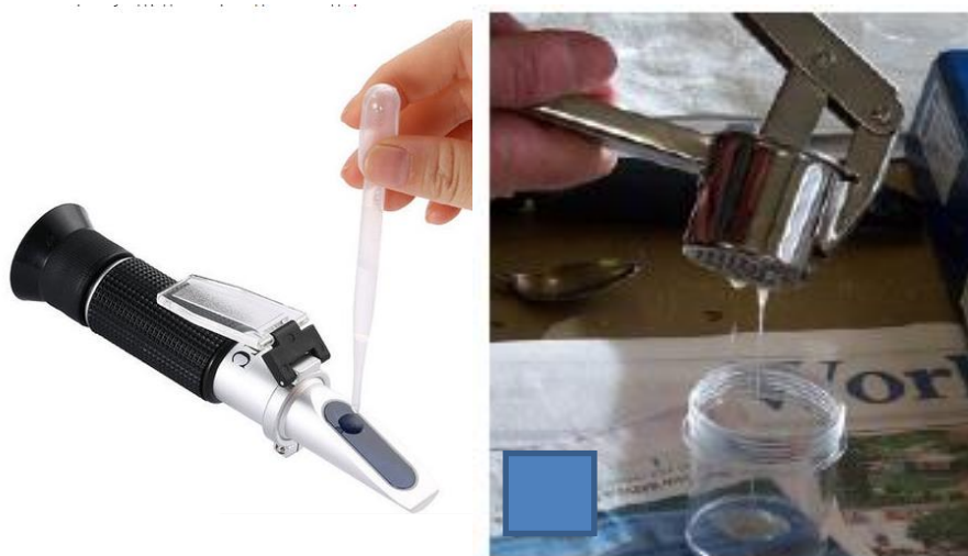
Рис. 3. Процедура отримання соку із коренів спаржі та визначення у ньому вмісту цукрів за допомогою польового рефрактометра
