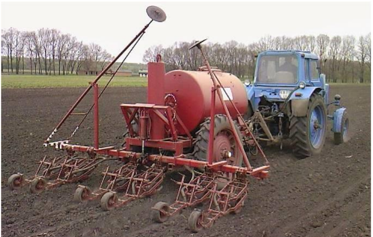
Рис. 3.2–3.3. Процес висіву пророщеного насіння томата гідросівалкою у захищеному ґрунті для вирощування розсади без технічного обігріву. Роботу агрегату контролює автор і талановитий винахідник Ольховський М. Ф.
