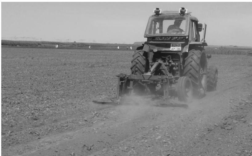
Рис. 1 – Проведение плоскорезной обработки на опытном участке
