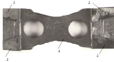
Рисунок 2. Конструкція молотка-модуля (основа 1-сталь Ст.3, сталь 45; 2-модульні пластини – вставки з порошкового композиційного матеріалу КХЖ70, КХНФ15.); кормодробарка ДБ-5 (ДЗ-3), КДУ-2,0
