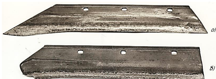
Рисунок 1. Леміш серійний зміцнений сплавом ПГ-С27
